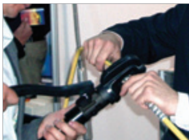
Опрессовщик 15В. Опрессовка соединительной гильзы 95 мм 2
