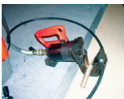
Резка арматуры диаметром 25 мм универсальным неавтономным резак SP-32
