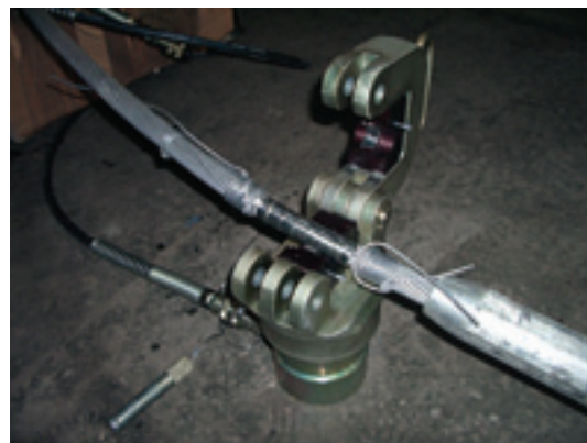
Пресс EP-520C. Опрессовка анкерного зажима соединителя САС-300-1.
