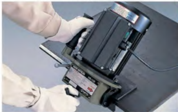
снятие фаски с кромки металлического листа
