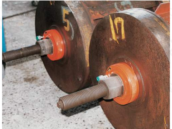
Гидравлический домкрат 1000кН, ход штока 350мм
