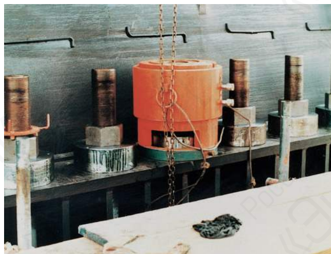
Гидравлический натяжитель болтов 5000 кН
