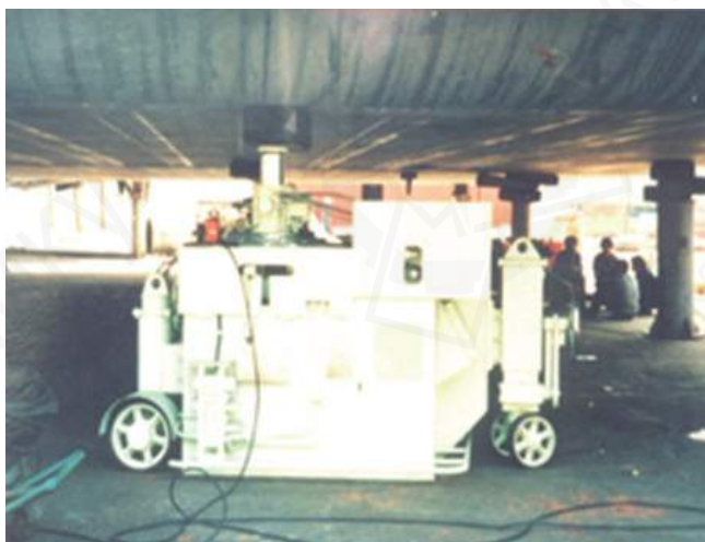
Устройство для регулировки местоположения корпуса судна 2000кН
