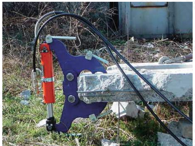
Ручная дробилка ( корпус домкрата из сплава титана)
