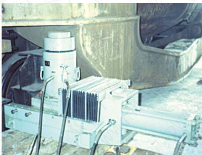
Гидравлический домкрат на скользящей опоре 500кН, 200мм и электрический насос GH2-P
