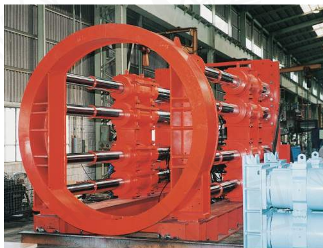
2000кН, 8 цилиндров, ход штока 3000мм
