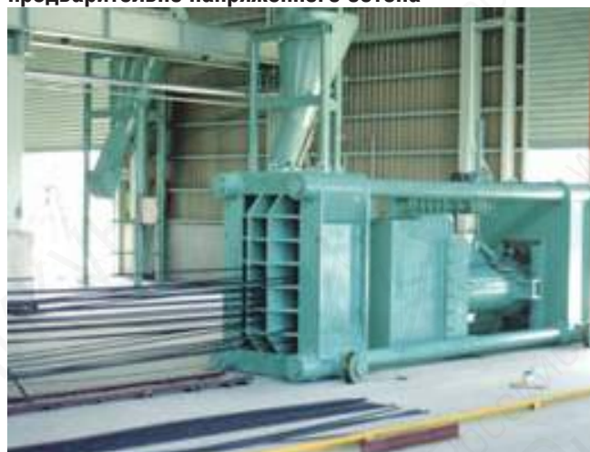
Гидравлические системы 1500кН,7000кН
