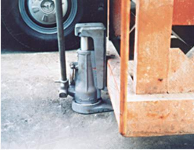
Механический домкрат с подхватом 250кН
